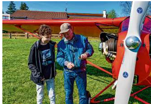
Die Ruder sind nicht aus Metall, sondern mit Stoff bespannt. Sie müssen vor dem Abflug geprüft werden.
