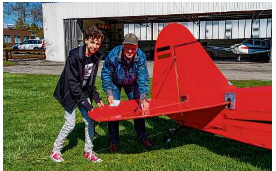
Die Ruder sind nicht aus Metall, sondern mit Stoff bespannt. Sie müssen vor dem Abflug geprüft werden.
